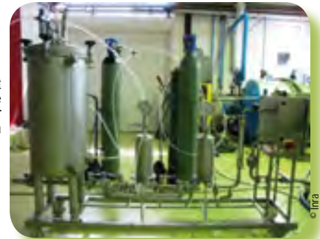
Ligne de conditionnement lots expérimentaux palette de filtration avec contacteur membranaire RS IW -Inoxpa
