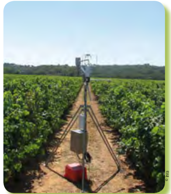
Figure 1. Dispositif de mesure directe de l'évapotranspiration par covariances turbulentes, installé sur la parcelle n° 7 lors des acquisitions d'images ASTER
