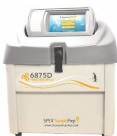
Le laboratoire est désormais équipé d'un cryobroyeur. Il permettra le broyage simultané dans l'azote liquide de 8 échantillons. Il permettra donc de travailler plus rapidement et de façon plus sécurisée. Marie-Cécile pourra vous en expliquer le fonctionnement.
