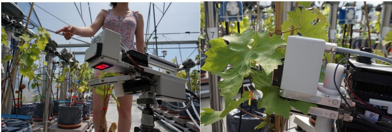
Légende : La mesure des **échanges gazeux** témoigne de l'interaction des plantes avec l'environnement et renseignera sur la réponse des stomates au pathogène et à la sécheresse. L'analyseur d'échanges gazeux photographié ici permet de mesurer la quantité de CO<sub>2</sub> et d'eau échangée entre la feuille et l'air.
