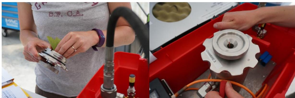
Légende : Le **statut hydrique** atteste du niveau de stress subit par les plants. Il s'agit concrètement de mesurer la tension dans la colonne d'eau de la plante (potentiel hydrique) à l'aide d'une chambre à pression.
